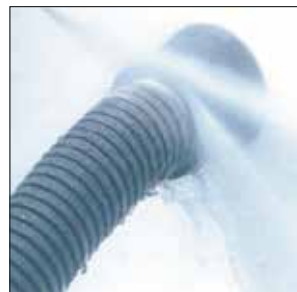
防护性能测试 IEC60529 IP test
